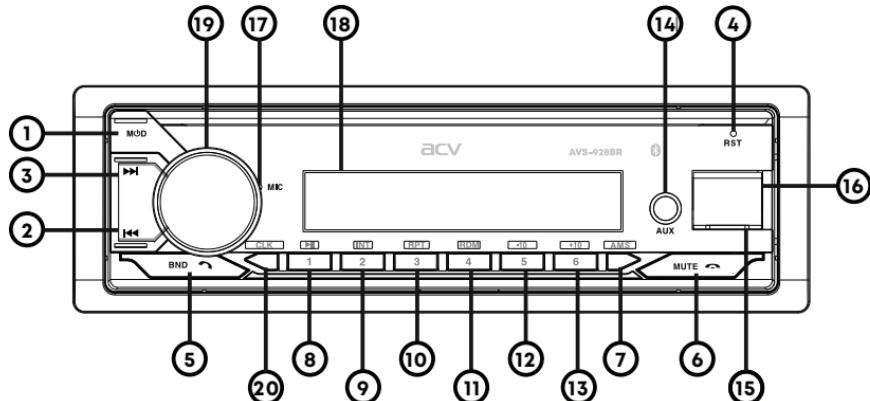
1. **M&D** - Кнопка включения/выключения устройства, выбора режимов ресивера.
