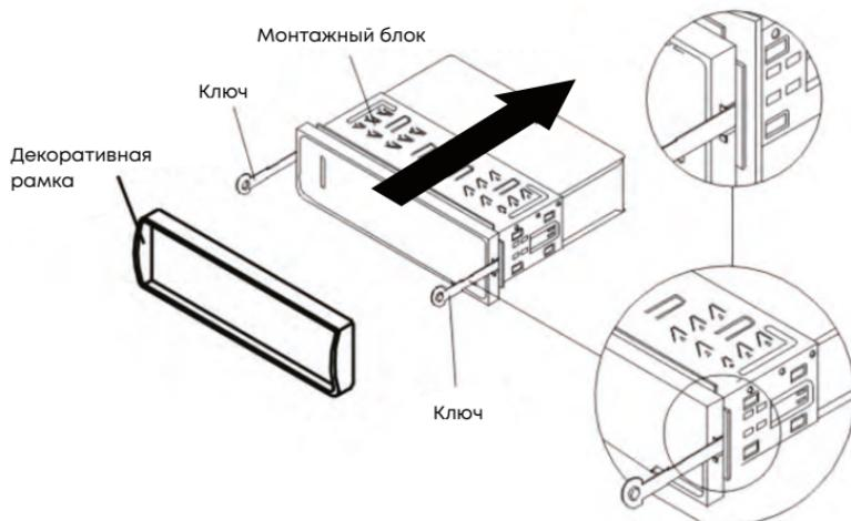
2) Вставьте монтажную раму (без корпуса проигрывателя) в отсек приборной панели и отогните «язычки» при помощи отвертки. Не все «язычки» подходят под конструкцию приборной панели конкретного автомобиля, выберите наиболее подходящие.
