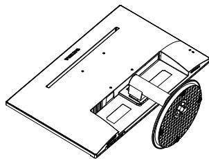
2. Нажмите фиксаторы, чтобы отсоединить подставку монитора от основания.
