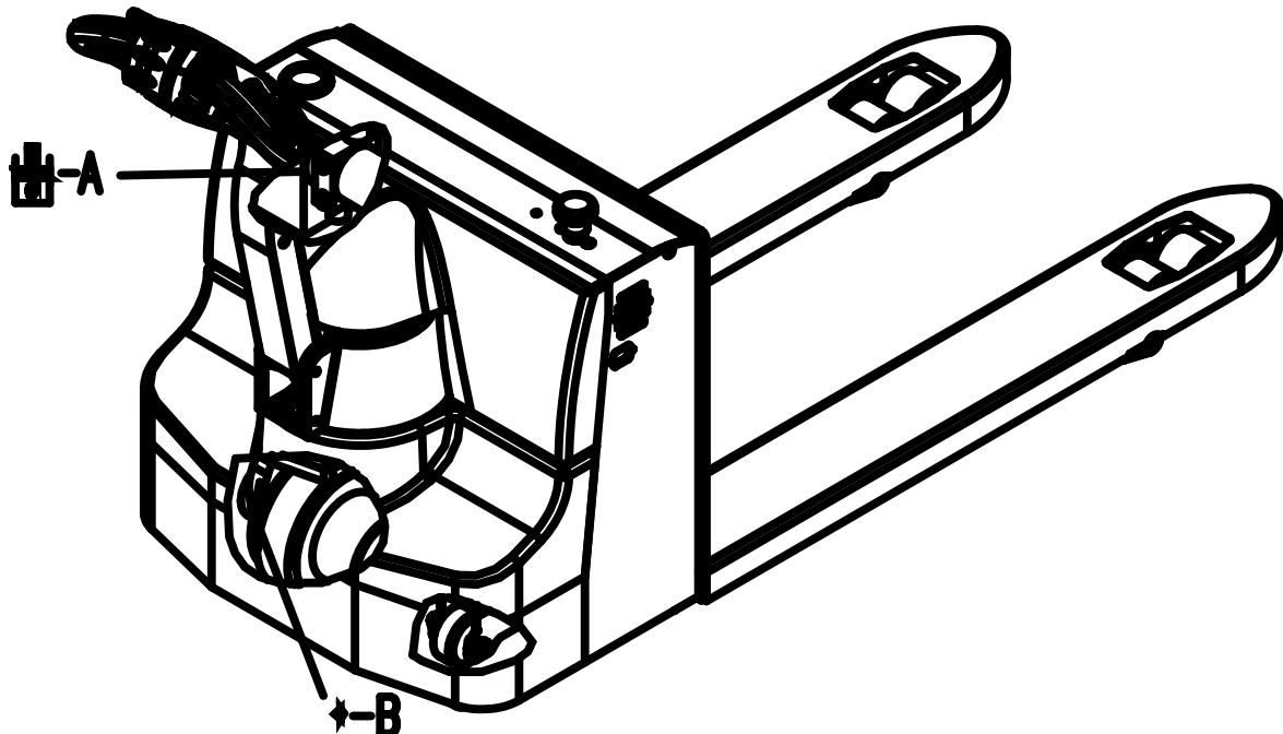
Отверстие для заливки гидравлического масла
