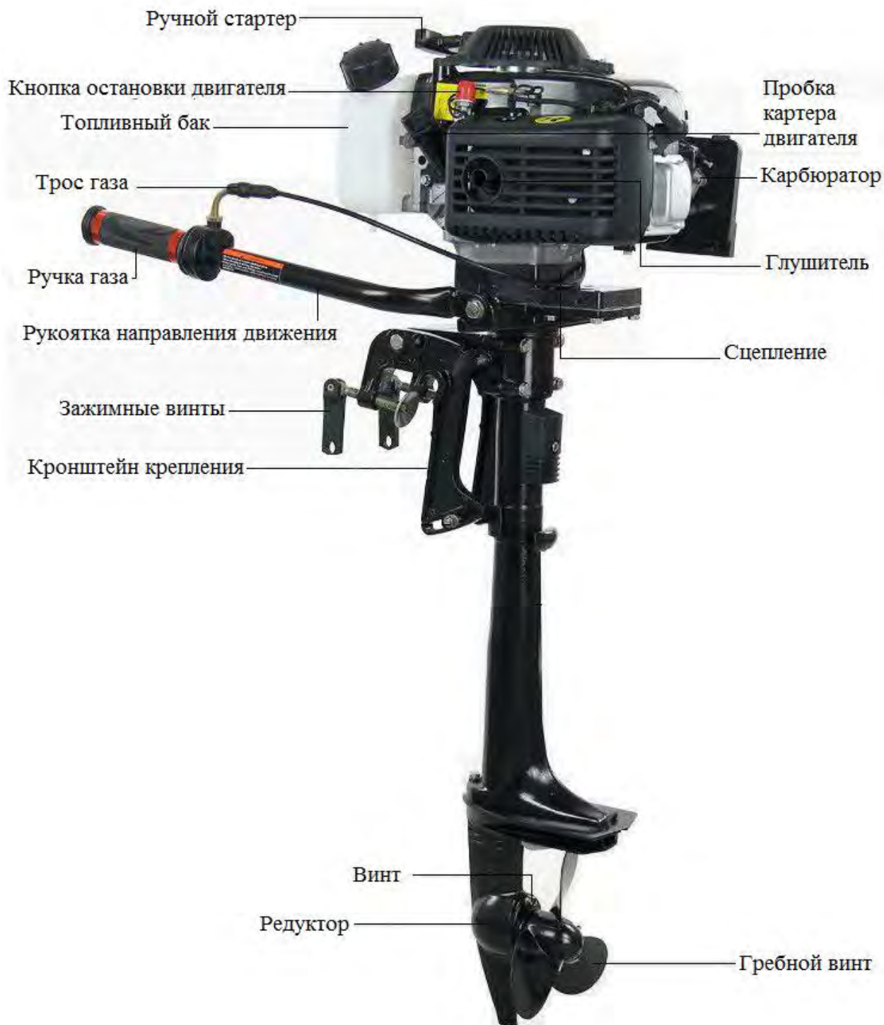
Рисунок 1 – Устройство лодочного мотора
