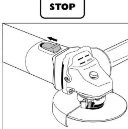
Прежде чем начать работы, всегда дожидайтесь, когда шлифмашина после включения наберет рабочие обороты. Запрещается включать шлифмашину с заблокированным диском.
