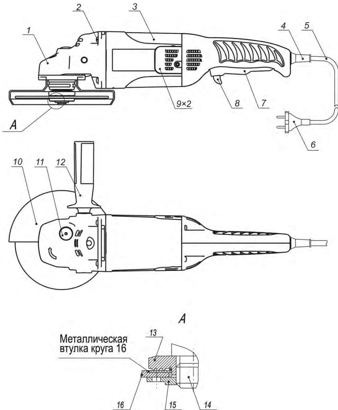
1 - редуктор; 2 - винт; 3 - электропривод; 4 - защитная втулка; 5 - шнур питания;
