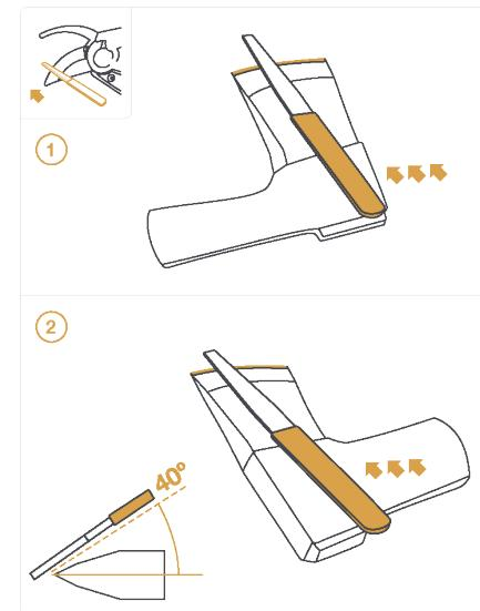
5. Завершите заточку, используя более мягкую сторону напильника. Проведите напильником по плоской стороне лезвия один раз, чтобы удалить заусенцы, возникшие в результате заточки.
