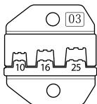
Опрессовка одинарных изолированных и неизолированных втулочных наконечников
