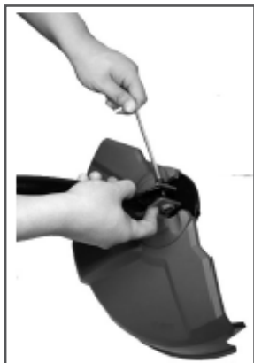
Рис. 3 Установка защитного кожуха
