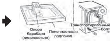
Снимите транспортировочные болты и опоры.
