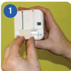
1 Снимите крышку батарейного отсека на задней стенке iT300 блока.
