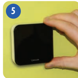
5 Опустите блок до упора. Убедитесь, что он надежно зафиксирован на кронштейне.
