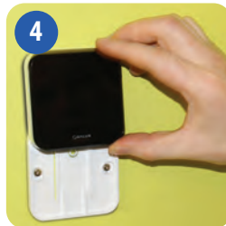
4 Совместите канавку на задней стенке iT300 блока и выступ на кронштейне.
