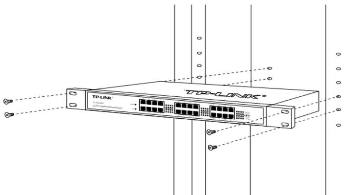
Рисунок 2-2 Затяните шурупы на стойке
