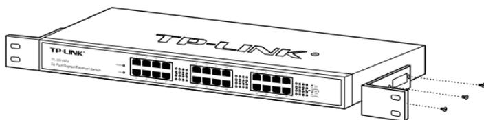
Рисунок 2-1 привинтите L-образные рейки к боковым сторонам коммутатора
