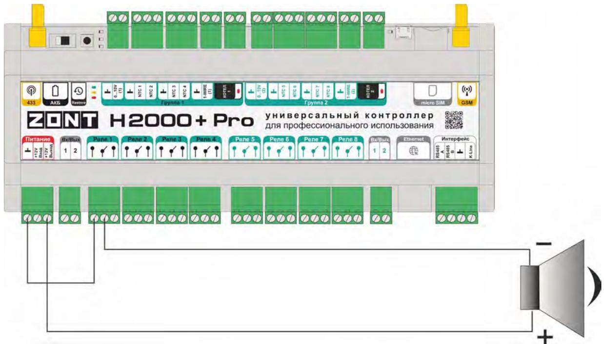
Схема подключения светозвуковой сирены:
