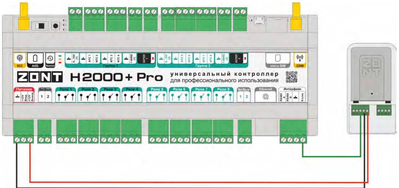
Схема подключения адаптера по **RS-485**.
