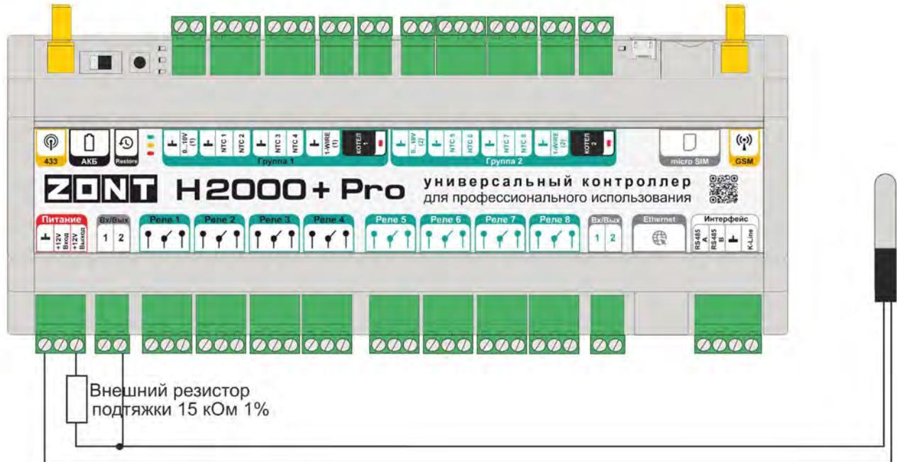
При таком подключении датчика NTC-10 требуется использовать между входом и клеммой питания “+12 В” дополнительный внешний резистор 15 кОм 1%.
