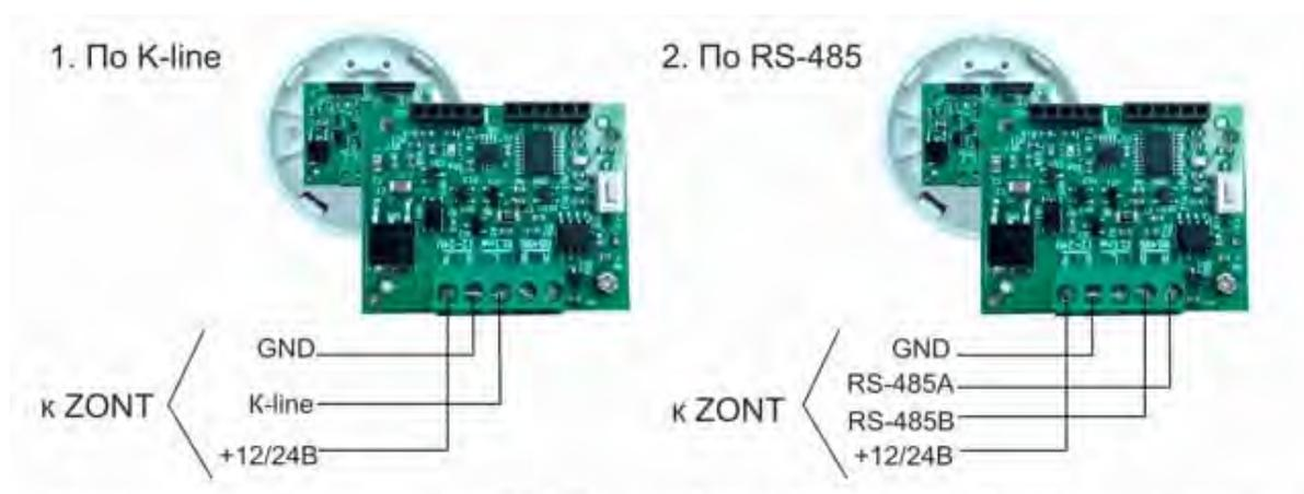
К Контроллеру датчики подключаются через входы RS-485 или через вход K-Line.
