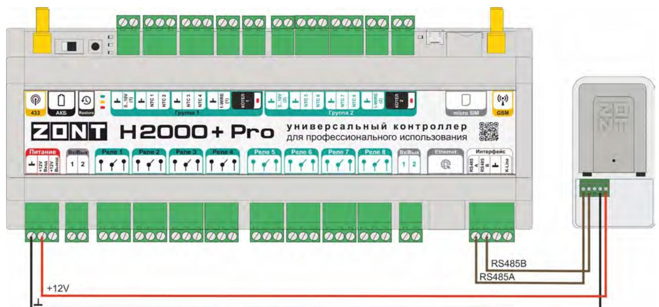
Схема подключения радиомодуля по **K-Line**:
