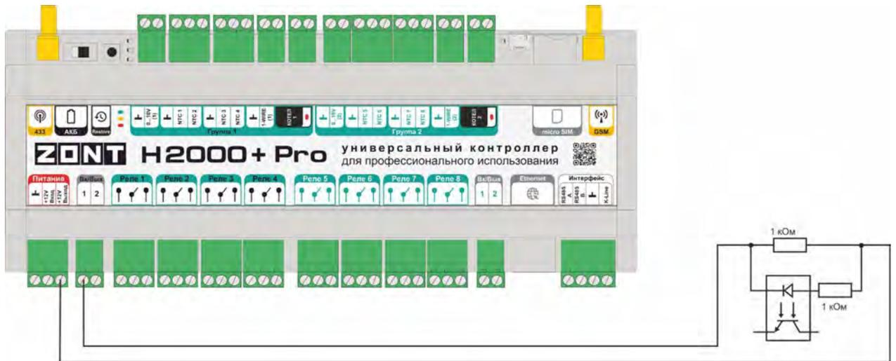
Низковольтные звуковые и светозвуковые сирены (+12В) допустимо подключать непосредственно к выходу контроллера. Схема подключения звуковой сирены:
