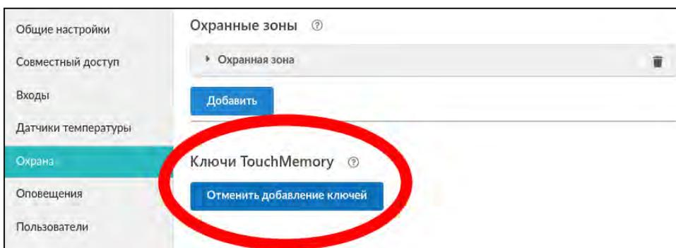
Затем включить режим добавления ключа и подключить ключ на короткое время – появится новый ключ с уникальным номером и можно будет настроить действия при касании ключа:
