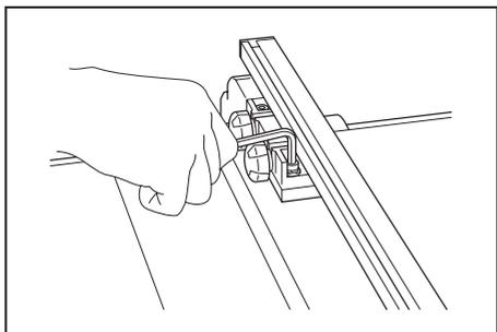
**ВНИМАНИЕ:** Убедитесь, что направляющая планка после регулировки располагается параллельно пильному диску; в противном случае возникает вероятность отдачи.
