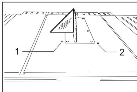
► 1. Регулировочный винт  $90^\circ$  2. Регулировочный винт  $45^\circ$
