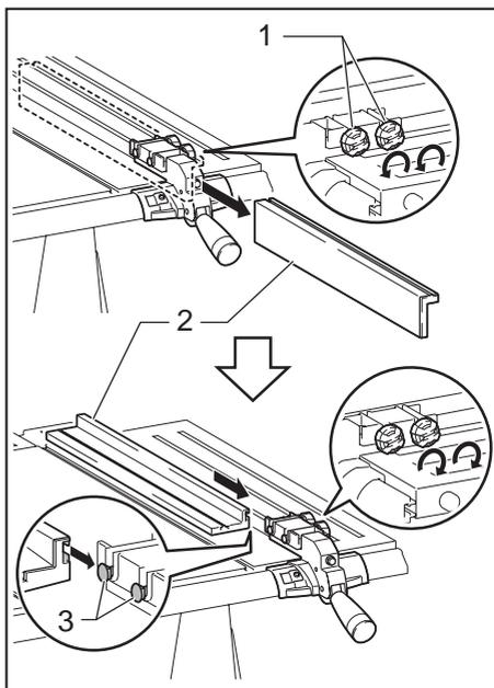
► 1. Гайка 2. Направляющая планка 3. Головка болта
