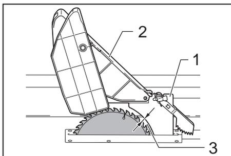
▶ 1. Расклинивающий нож 2. Ограждение диска 3. Зазор 4 мм – 5 мм
