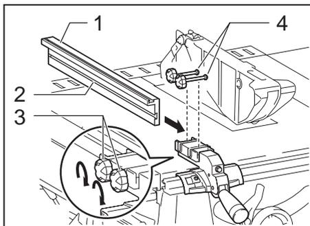
► 1. Направляющая планка 2. Канавка 3. Гайка 4. Головка болта
