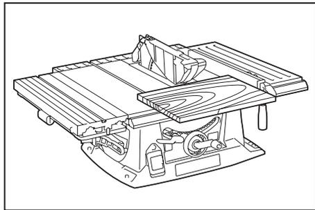
2. Расположите направляющую планку по нужной ширине реза и зафиксируйте ее, повернув ручку. Перед началом резки убедитесь в том, что задний конец направляющей планки прочно зафиксирован. Если он зафиксирован недостаточно, выполните действия, описанные в разделе “Установка и регулирование направляющей планки”.
