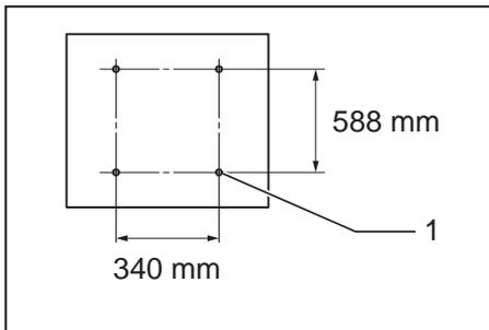
▶ 1. Диаметр отверстия 8 мм
