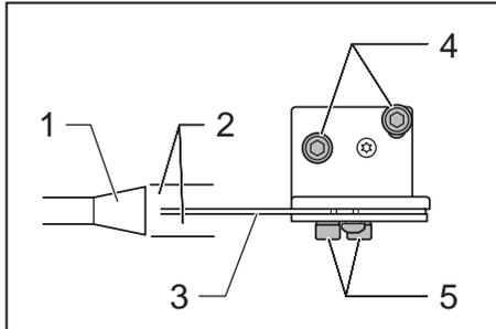
▶ 1. Пильный диск 2. Эти два зазора должны быть одинаковыми. 3. Расклинивающий нож 4. Болты с шестигранными головками (B) 5. Болты с шестигранными головками (A)
