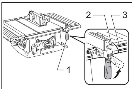
▶ 1. Рычаг 2. Держатель планки 3. Направляющий рельс
