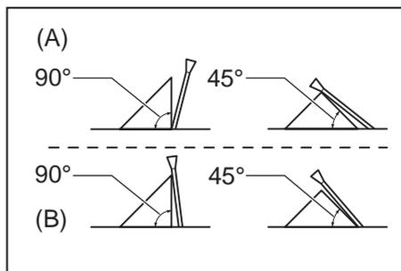
Станок оснащен неподвижными упорами под углом  $90^\circ$  и  $45^\circ$  к поверхности стола. Для проверки и настройки неподвижных упоров действуйте следующим образом:
