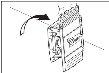
**ВНИМАНИЕ:** Обеспечьте опору для инструмента во избежание его падения. Рекомендуется, чтобы кто-то поддерживал инструмент.
