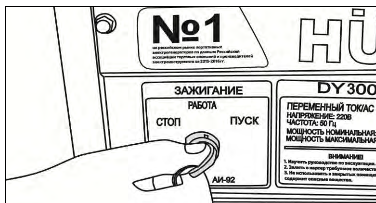
Рис. 17. Запуск двигателя электростартером
