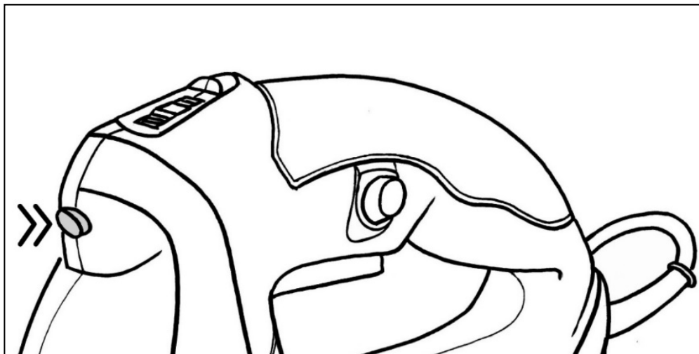
Рис. 8. Включение лазера/подсветки на модели Л-100/850
