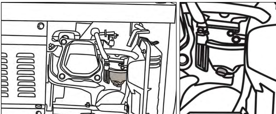
Рис. 26. Слив топлива из карбюратора
