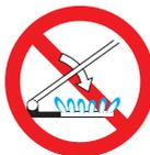
Символ на стеклянной крышке плиты означает: Стеклопанель крышки может треснуть при нагревании. Погасите все конфорки перед тем, как ее опустить.
