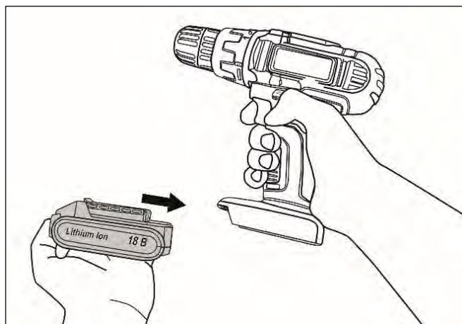
Рис. 6 Установка аккумулятора
