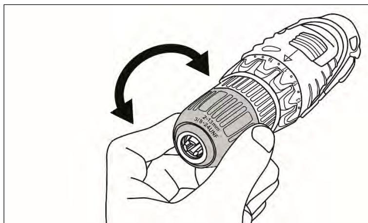
Рис. 6 Откручивание патрона
