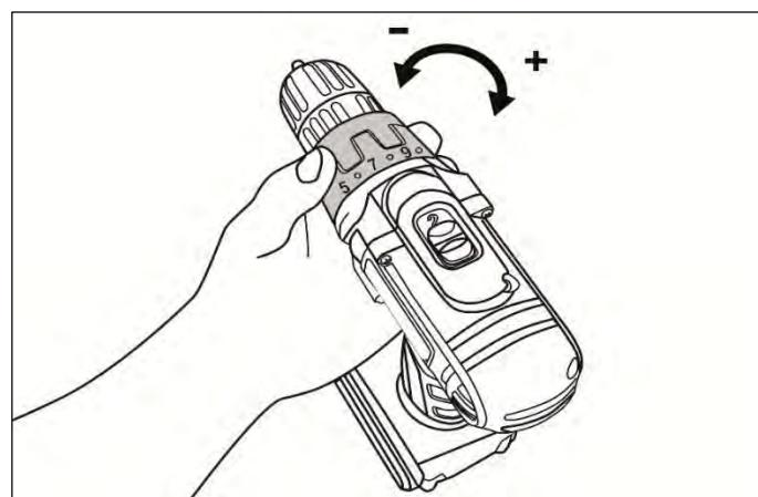
Рис. 7 Установка крутящего момента
