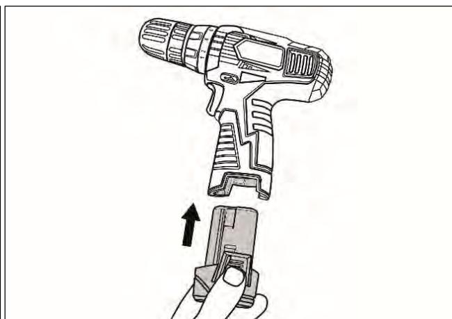
Рис. 7 Установка аккумулятора
