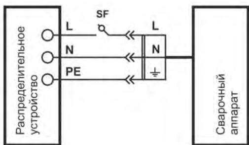
При подключении сварочного аппарата к электрической сети переменного тока напряжением 220 В и частотой 50 Гц необходимо обеспечить защиту розетки для подключения автоматическим выключателем или плавкой вставкой с током срабатывания соответствующим максимальному току потребляемому аппаратом.
