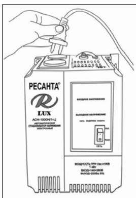
Рис. 4. Подключение нагрузки и включение
