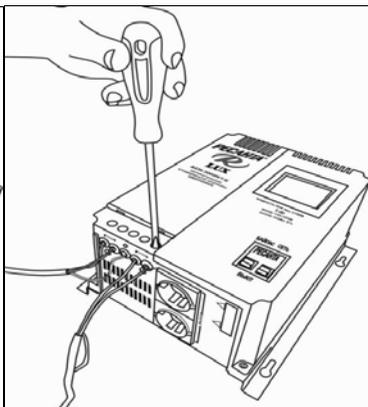
Рис. 8. Подключение нагрузки
