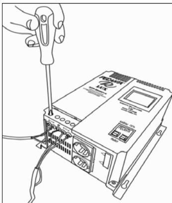
Рис. 7. Подключение стабилизатора
