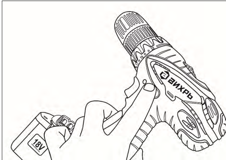
Рис. 11 Переключения направления вращения (реверс)
