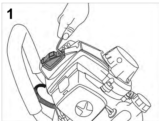
Рис. 14. Откручивание винта и снятие пластиковой крышки
