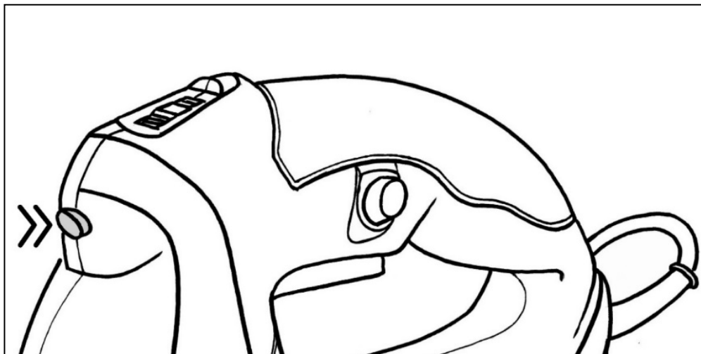
Рис. 8. Включение лазера/подсветки на модели Л-100/850
