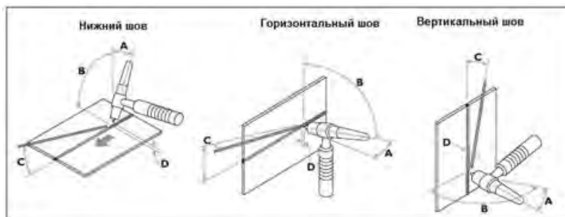
Рисунок. Базовые движения при работе с аргодуговой горелкой А - Диапазон движения горелки 10-20°. В - Рабочий угол 90° к свариваемой поверхности. С - Угол подачи сварочного прутка. D - Высота дуги 1-1,5 диаметра электрода.
