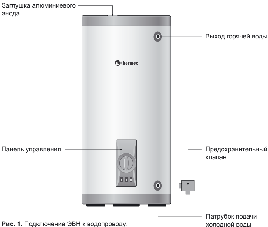
Рис. 1. Подключение ЭВН к водопроводу.
