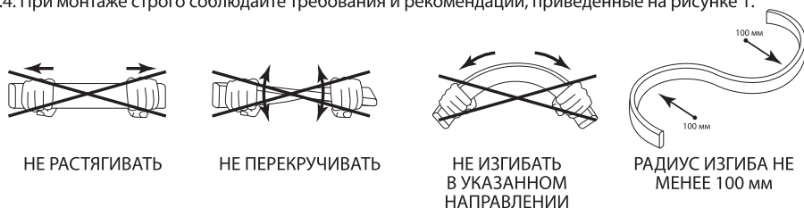
Рисунок 1. Требования и рекомендации для монтажа гибкого неона.
