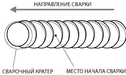
Рис. 9.4. Начало сварки при смене электрода.
