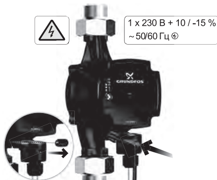
Рис. 9 Подключение сигнального кабеля к ALPHA1
