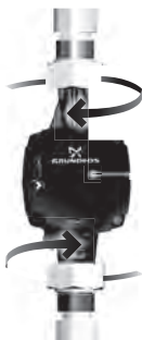
Նկար 4 Պոմպի տեղակայման օրինակներ
