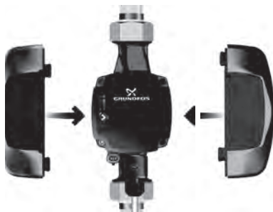
Рис. 7 Установка теплоизолирующего кожуха
