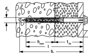
**SXRL-FUS – fischer 6-kant-Sicherheitschraube, angeformte U-Scheibe und integrierte Bit-Aufnahme**
