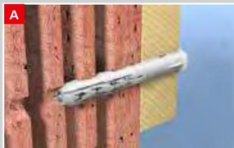
**A In Lochbaustoffen** werden die Lasten im Bereich der Steinstege übertragen.
