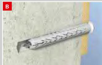
**B In Vollbaustoffen und Porenbeton** vereinen sich die zwei Spreizonen zu einem langen Spreizelement und garantieren eine gleichmäßige, flächige Lastverteilung in den Untergrund.
