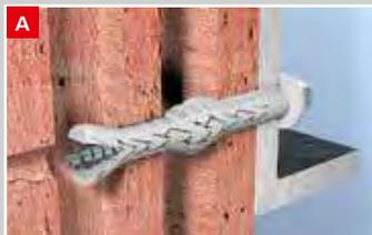
**A In Lochbaustoffen** wird durch die zwei Spreizonen eine untergrundschonende Krafteinleitung gewährleistet. Die porösen Steinstege werden durch die Spreizonen nicht zerstört und können dadurch zur Kraftweiterleitung herangezogen werden.
