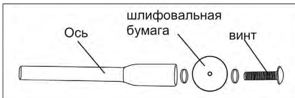
Рис.5 Установка диска из шлиф бумаги
