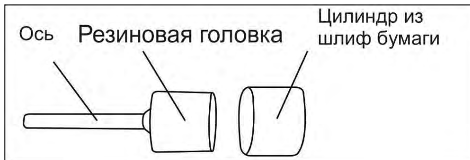
Рис.6 Установка цилиндра из шлиф бумаги
