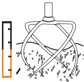
2. Закручивающим движением по часовой стрелке погружаем зубья культиватора в землю. Глубина зависит от плотности почвы: чем плотнее почва, тем меньше глубина. Рекомендуемая глубина первичного погружения не более чем  $1/2$  от высоты зубьев.
