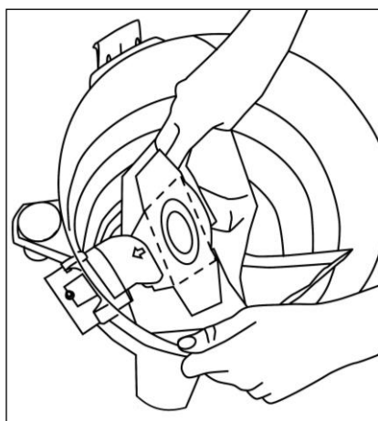
Рис. 5 Установка мешка для сбора пыли
