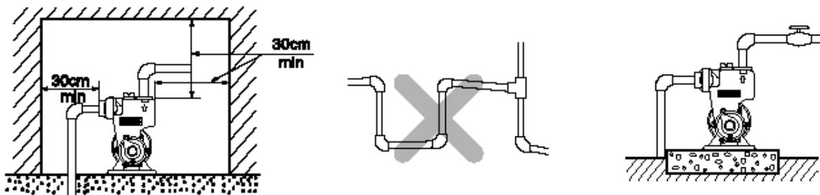
■ Для установки насоса выберите место, где насос может быть доступен для монтажа, проверки и ремонта. При установке насоса в комнате соблюдайте размеры как показано на рисунке.
