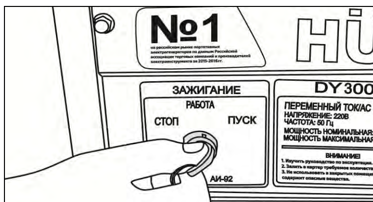
Рис. 17. Запуск двигателя электростартером
