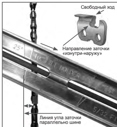
Рис. 18 Определение угла заточки
