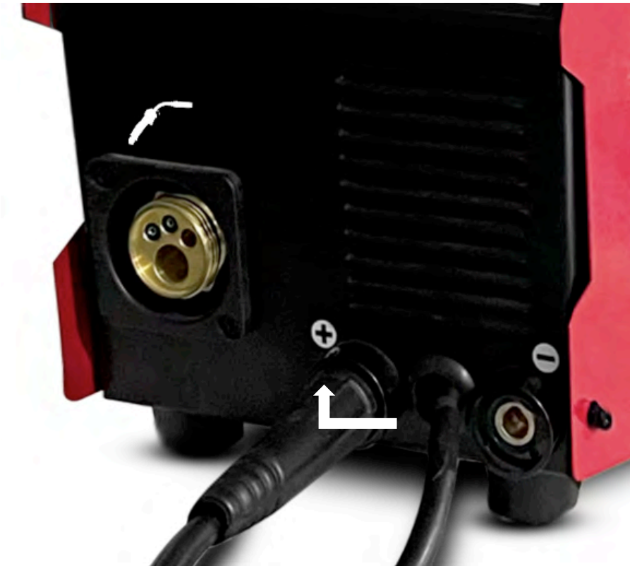
Сварка в режиме MIG с газом CO 2
