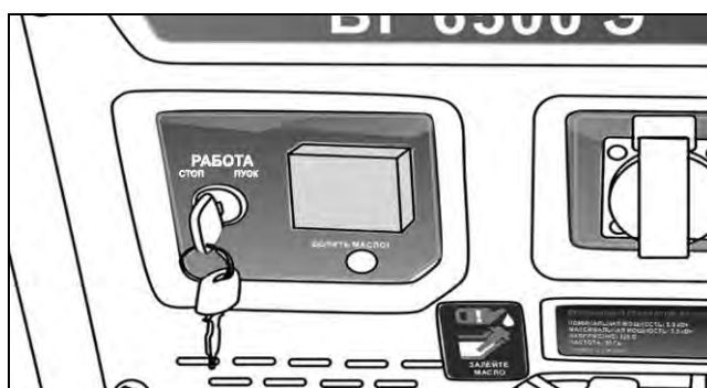
Рис. 20. Многофункциональный цифровой дисплей.
