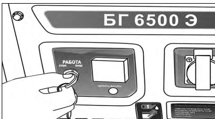
Рис. 17. Запуск двигателя электростартером
