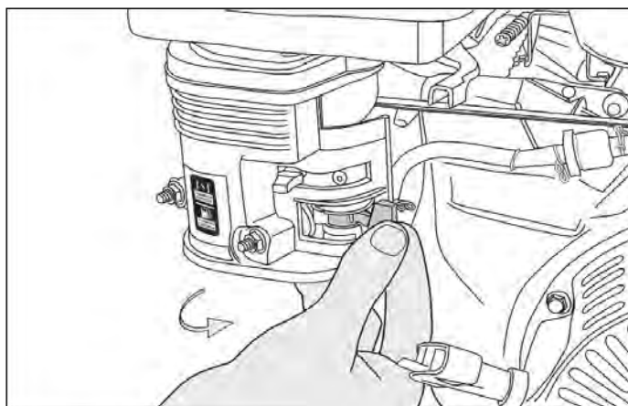
Рис. 21. Открытие топливного крана
