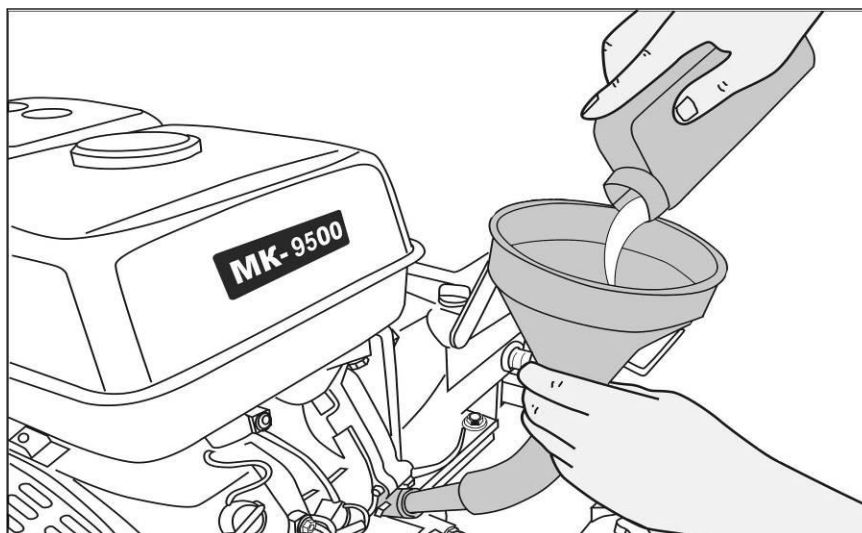
Рис. 17. Заливка масла в двигатель
