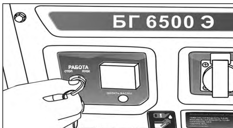
Рис. 17. Запуск двигателя электростартером
