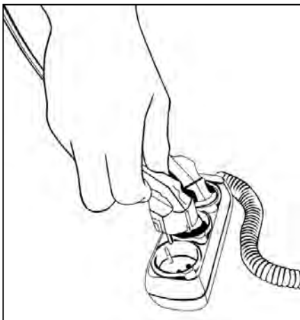
Рис.7 Подключение пилы к сети
