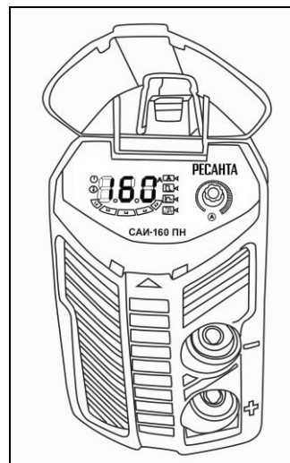
Рис. 7. Отображение выходного тока на дисплее
