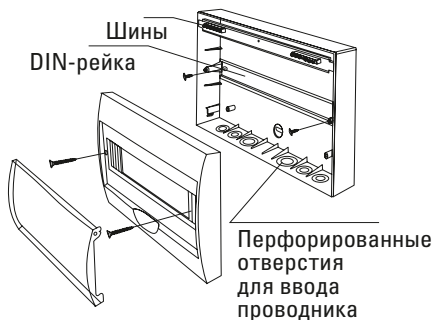
Рис. 1 - Схема монтажа ЩРН-П
