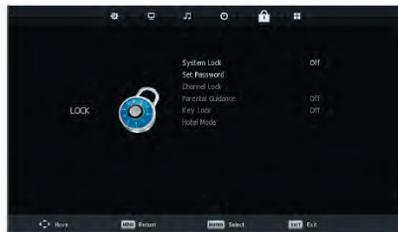
1. С помощью кнопок «▲/▼» выберите пункт меню настройки блокировки системы «System Lock», после чего с помощью кнопок «◀ / ▶» выберите вариант «включения» или «отключения».
