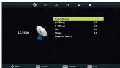
1. С помощью кнопок «▲▼» выберите пункт меню режима автоматической настройки «Auto Adjust», после чего с помощью кнопки ввода «ENTER» перейдите к настройке.
