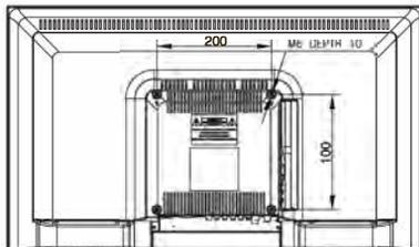
3. Установите две резиновые прокладки в отверстия винтовых креплений в нижней части задней панели телевизора.
