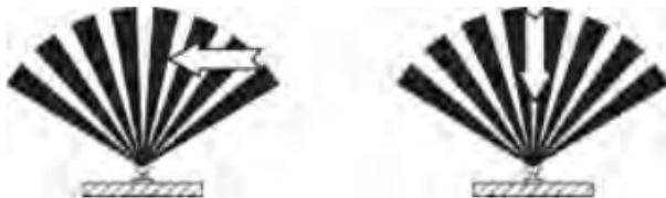
ния датчика объекты, которые могут приводить к его ошибочным срабатываниям. Для этого необходимо избегать установки датчика вблизи зон температурного возмущения (кондиционер, отопление) и вентиляторов.
