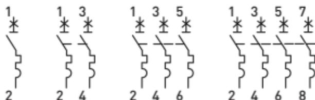
Рис. 3. Схемы подключения
