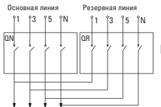
Схема соединения 4-х полюсного АВР
