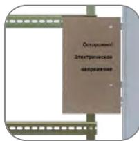
Электроизоляционный картон закрывает токоведущие части
