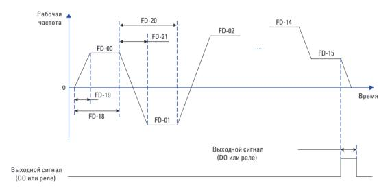
Параметрами с четными номерами из диапазона FD-18~FD-49 настраивается время работы каждой ступени, с нечетными номерами — Время ускорения/замедления для каждой ступени.
