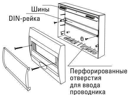
Рис. 1 - Схема монтажа ЩРН-П
